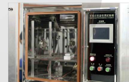
03. 高低温测试 (确保-40°C~60°C恶劣环境应用的可靠性)
