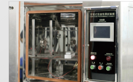
03.高低温测试 (确保-30°C~60°C恶劣环境应用的可靠性)
