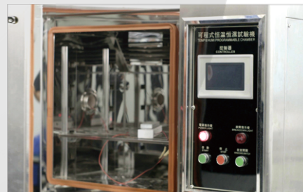
03. 高低温测试 (确保-30°C~60°C恶劣环境应用的可靠性)
