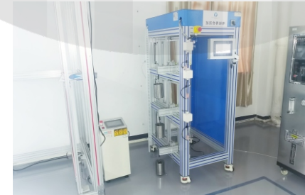
05. 电锁耐用测试设备 (意林350kg磁力锁通过100万次耐用测试)
