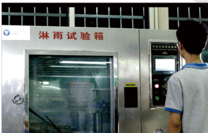
04. 磁力锁雨淋测试设备 (确保产品在户外环境性能的可靠性)
