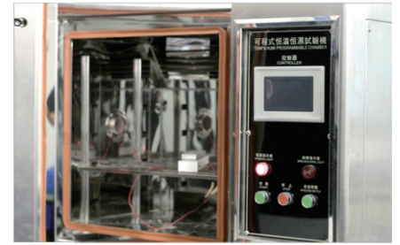
03.电插锁高低温测试 (确保-40℃~60℃恶劣环境应用的可靠性)
